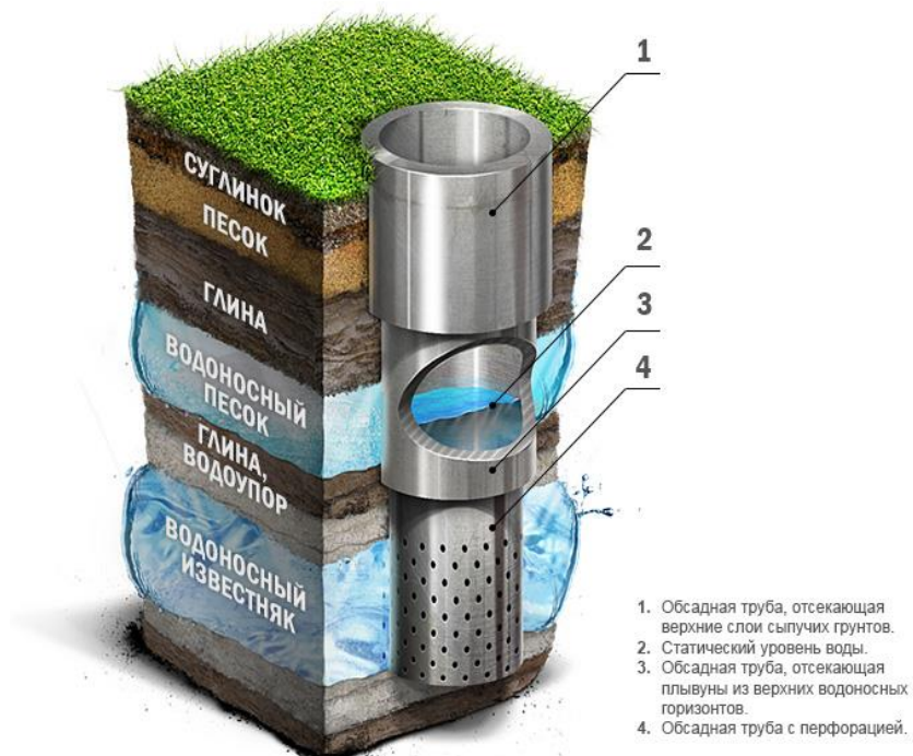
Рисунок 6. Схема артезианской скважины.
